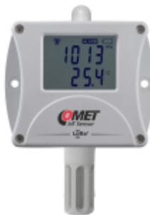
El sensor **W7910** con salida de red **LoRaWAN** mide la temperatura, humedad y presión atmosférica mediante sensores internos integrados, y puede instalarse directamente en el entorno de medición gracias a su carcasa con certificación **IP65**. Los dispositivos LoRa funcionan con una batería reemplazable que tiene una duración de hasta 10 años (3 años estándar).
