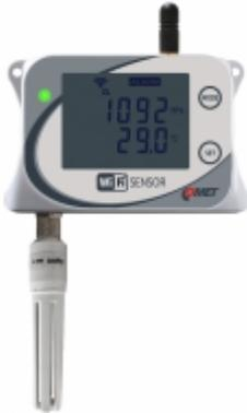
Los sensores con interfaz WiFi están diseñados para medir la temperatura, la humedad relativa y la presión atmosférica con una sonda conectada (incluida en la entrega).
