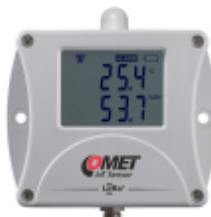
El sensor **W3911** con salida de red **LoRaWAN** mide la temperatura y la humedad mediante una sonda externa con cable, y puede instalarse directamente en el entorno de medición gracias a su carcasa con certificación **IP65**. Los dispositivos LoRa funcionan con una batería reemplazable que tiene una duración de hasta 10 años (3 años estándar).
