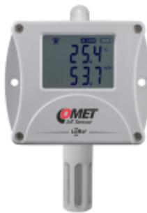
El sensor **W3910** con salida de red **LoRaWAN** mide la temperatura y la humedad mediante un sensor interno integrado y puede instalarse directamente en el entorno de medición gracias a su carcasa con certificación **IP65**. Los dispositivos LoRa funcionan con una batería reemplazable que tiene una duración de hasta 10 años (3 años estándar).
