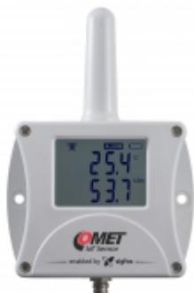
El instrumento mide la temperatura y la humedad de la sonda externa. Presenta un diseño simple y compacto y se coloca directamente en el área medida. Los valores medidos se muestran en la pantalla y se envían regularmente, en un intervalo de tiempo ajustable (10 min a 24 h), por transmisión de radio de Sigfox a COMET Cloud.
