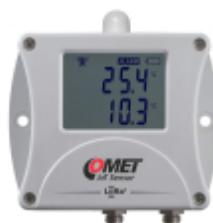
El sensor **W0932** con salida de red **LoRaWAN** mide la temperatura mediante un sensor integrado y dos sondas externas **Pt1000** con cable. Puede instalarse directamente en el entorno de medición gracias a su carcasa con certificación **IP65**. Los dispositivos LoRa funcionan con una batería reemplazable que tiene una duración de hasta 10 años (3 años estándar).
