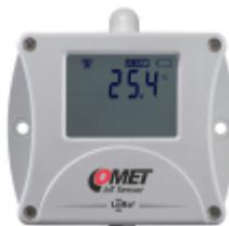
El sensor **W0911** con salida de red **LoRaWAN** mide la temperatura mediante una sonda externa **Pt1000** con cable y puede instalarse directamente en el entorno de medición gracias a su carcasa con certificación **IP65**. Los dispositivos LoRa funcionan con una batería reemplazable que tiene una duración de hasta 10 años (3 años estándar).
