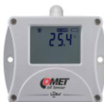
El sensor **W0910** con salida de red **LoRaWAN** mide la temperatura mediante un sensor integrado y puede instalarse directamente en el entorno de medición gracias a su carcasa con certificación **IP65**. Los dispositivos LoRa funcionan con una batería reemplazable que tiene una duración de hasta 10 años (3 años estándar).
