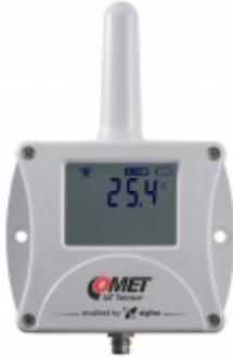
El instrumento mide la temperatura de un sensor externo. Presenta un diseño simple y compacto y se coloca directamente en el área medida. Los valores medidos se muestran en la pantalla y se envían regularmente, en un intervalo de tiempo ajustable (10 min a 24 h), por transmisión de radio de Sigfox a COMET Cloud.
