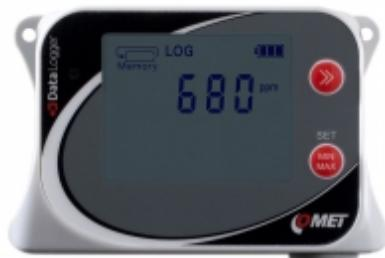
Data Logger diseñado para el registro de CO<sub>2</sub> desde un sensor integrado. En caso de que se rebasen los límites preestablecidos de alarma, se indicará con un LED, en la pantalla LCD y acústicamente.
