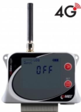
El registrador de datos 4G está diseñado para registrar cuatro entradas binarias o dos entradas de pulsos y dos entradas binarias. En caso de exceder los límites establecidos, se pueden enviar mensajes SMS y JSON a gracias a la conexión de datos 4G. Los valores medidos pueden ser enviados a la nube de almacenamiento COMET Cloud, que es un completo software de monitoreo, alarma y análisis de datos.
