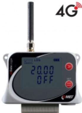
4G Datalogger está diseñado para registrar 3 entradas de corriente y 1 entrada binaria. En caso de exceder los límites establecidos, se pueden enviar mensajes SMS y JSON a gracias a la conexión de datos 4G. Los valores medidos pueden ser enviados a la nube de almacenamiento COMET Cloud, que es un completo software de monitoreo, alarma y análisis de datos.
