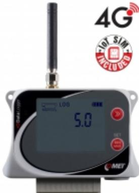
El datalogger 4G está diseñado para registrar 3 entradas de voltaje y una entrada de dos estados. En el caso de que los límites preestablecidos se excedan, se envían mensajes SMS y JSON vía conexión 4G. Los valores medidos se pueden enviar al almacenamiento de Internet COMET Cloud, que es un sistema completo de monitoreo, alarma y análisis.
