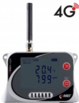
El registrador de datos 4G está diseñado para registrar la temperatura, la humedad, la presión atmosférica y el CO2. En caso de exceder los límites establecidos, se pueden enviar mensajes SMS y JSON a gracias a la conexión de datos 4G. Los valores medidos pueden ser enviados a la nube de almacenamiento COMET Cloud, que es un completo software de monitoreo, alarma y análisis de datos.
