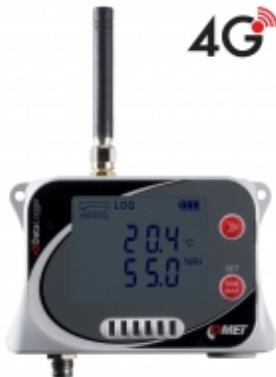
El registrador de datos 4G está diseñado para registrar la temperatura y la humedad desde sensores incorporados y desde una sonda de temperatura externa. En caso de exceder los límites establecidos, se pueden enviar mensajes SMS y JSON a gracias a la conexión de datos 4G. Los valores medidos pueden ser enviados a la nube de almacenamiento COMET Cloud, que es un completo software de monitoreo, alarma y análisis de datos.
