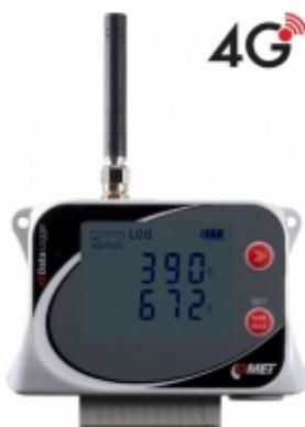
Datalogger diseñado para registrar la temperatura de tres termopares, una sonda Pt1000 y un sensor de temperatura interno. En caso de que se superen los límites establecidos, se pueden enviar mensajes SMS y JSON a través de la conexión de datos 4G. Los valores medidos pueden enviarse al almacenamiento en Internet COMET Cloud, que es un completo sistema de supervisión, alarma y análisis.
