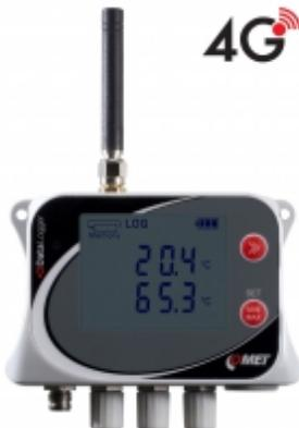
El datalogger 4G está diseñado para registrar temperatura desde una sonda externa Pt1000. En caso de exceder los límites establecidos, se pueden enviar mensajes SMS y JSON a gracias a la conexión de datos 4G. Los valores medidos pueden ser enviados a la nube de almacenamiento [COMET Cloud](#), que es un completo software de monitoreo, alarma y análisis de datos.
