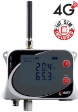
El datalogger GSM está diseñado para registrar temperatura desde una sonda externa Pt1000. En caso de exceder los límites establecidos, se pueden enviar mensajes SMS y JSON a gracias a la conexión de datos 4G. Los valores medidos pueden ser enviados a la nube de almacenamiento [COMET Cloud](#), que es un completo software de monitoreo, alarma y análisis de datos.
