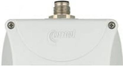
Versión del transmisor con conector macho estanca IP67 Lumberg RSFM4 en lugar de entrada de cables para una fácil conexión / desconexión de la salida. Especifique por favor en su pedido con la letra L detrás de código del modelo (por ejemplo TxxxxL).
