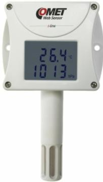
Sensor capacitivo de polímero de alta precisión que garantiza una excelente estabilidad de calibración a largo plazo y logra la máxima precisión. La LCD Dual Line es una ventaja. Los valores medidos también se convierten a otros de interpretación de humedad: temperatura del punto de condensación, humedad absoluta, humedad específica, proporción de mezcla y la entalpía específica.
