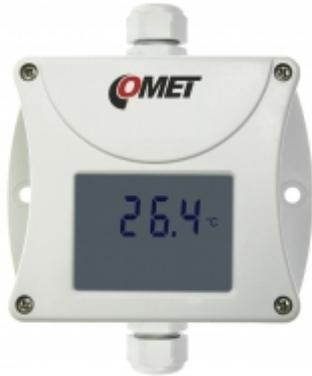
Transmisor de temperatura para sensor Pt1000/3850ppm con salida de 4-20 mA para la conexión de dos hilos construido en caja hermética duradera. El rango de temperatura de salida es ajustable por el usuario. Grados Celsius y Fahrenheit seleccionables por el usuario.
