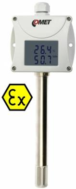
Transmisor de humedad y temperatura certificación ATEX. Uso en atmósferas potencialmente explosivas. Montaje en conducto. Sensores de temperatura y humedad relativa en eje de 150 mm.. Los valores medidos también se convierten a otros de interpretación de humedad: temperatura del punto de condensación, humedad absoluta, humedad específica, proporción de mezcla, entalpía específica.
