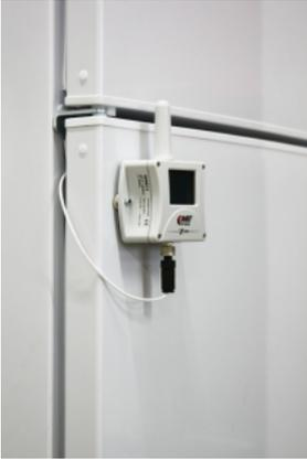
El kit incluye dos potentes imanes de neodimio con un acabado que sujeta de forma fiable el registrador de datos, incluidas las sondas, a superficies metálicas magnéticas. Material de conexión incluido. Para usar con el registrador de datos Uxxxx.
