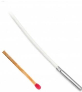
Las sondas están diseñadas para medir por contacto la temperatura de sustancias gaseosas y líquidas o sólidas. El diámetro ultradelgado de 3 mm de la carcasa garantiza una respuesta rápida a los cambios de temperatura. El tipo de cable de entrada utilizado tiene aislamiento de teflón con blindaje. Los sensores están diseñados para uso universal.
