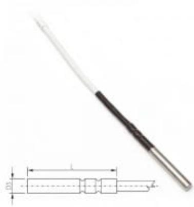
Acero inoxidable 17240 con cable de teflón de longitud especificada, con conector mini DIN. Diámetro  $5 \pm 0.1$  mm, longitud 50mm.
