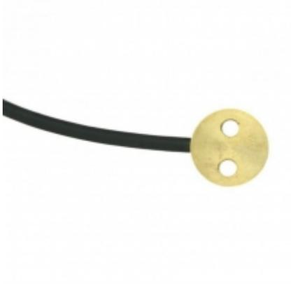
Sonda de superficie de latón con cable de longitud especificada, con conector MiniDIN. Rango de -30 a + 200 ° C, precisión  $\pm (0,15 + 0,002 | t |)$ . 18 mm de diámetro, 6,5 mm de ancho, 2 hilos.
