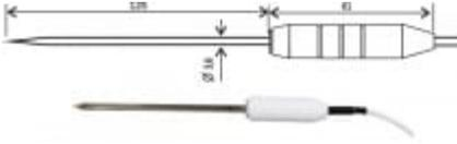
Sonda de temperatura con sensor Pt1000. Sonda con punta de penetración portátil de -30 a + 250 ° C, 17241 de acero inoxidable para la industria alimentaria con mango de teflón y cable de teflón de 10 metros, IP67. Tiempo de respuesta T63 (es)
