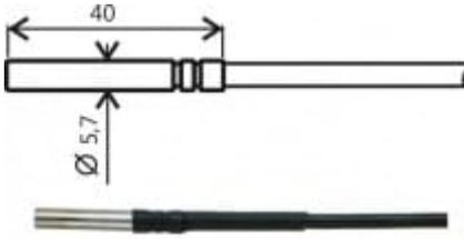
Sonda de temperatura con sensor Ni1000/6180 ppm.
