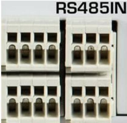
Por ejemplo, adquisición de datos de sensores de temperatura, presión, humedad Tx41x, Hx43x. Entrada diseñada para la lectura de los dispositivos que soportan el protocolo Modbus RTU o Advantech. La señal se conecta a los terminales MS6 directamente desde los terminales para los canales 15 y 16. Entrada C. 15 and 16. Input c (es)
