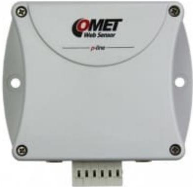
P-line Web Sensor para medición de temperatura, humedad relativa y tres entradas binarias para señales de dos estados. Alarma remota. Los dispositivos están equipados con dos conectores para la conexión de sondas externas de temperatura y humedad y tres entradas binarias para señales de dos estados. El contacto seco o señal de tensión de dos estados se pueden conectar a la entrada binaria.
