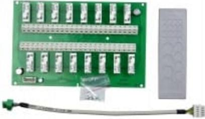
Módulo de relés para montaje en el interior de MS. Módulo de salida de relés con cable de interconexión. Contiene 16 relés de red voltaje máx. 50V AC/75V DC con contactos conmutados. Cada relé puede ser controlado basándose en la creación de alarma en diferentes canales de entrada de acuerdo a la configuración del programa de usuario. Los relés de salida están diseñados para el control de dispositivos externos (conmutación de calefacción, refrigeración, ventilación, alarma a distancia, etc.)
