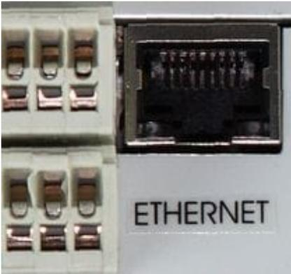
Interfaz LAN incorporado para registradores de datos MS6D, MS6R conexión a la red Ethernet (Internet). Comunicación a través de: SNMP, SOAP, www pages, Modbus TCP. En caso de que los límites se excedan la alarma se activa enviando a las direcciones especificadas aviso e-mail o trap SNMP.
