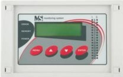
Terminal con pantalla dual line alfanumérica LCD y botones de control , indicación de alarma de audio y 32 LEDs de alarma - para montaje en panel o montaje en tapa de caja. Funciones idénticas al terminal incorporado del registrador de datos MS. Es posible fabricarlo con protección IP54. Longitud máxima del cable al registrador de datos: 50m. Es necesario pedir el cable de conexión al registrador de datos MP017., - . Identical functions as built-in terminal of MS data logger. (es)
