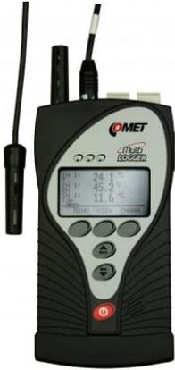
Registrador de datos universal con entrada hardware, sensor interno de presión barométrica con interfaz Ethernet.
