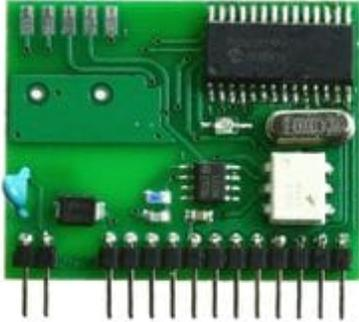
Entrada para medición de frecuencia de contacto conmutado 0 a 5kHz, resolución 1Hz, precisión  $\pm(0.2\%$  de lectura + 1Hz) resistencia máx. de contacto cerrado: 10 kohms resistencia mínima de contacto abierto: 250 kohms, duración mínima de entrada de impulsos: 30us, con aislamiento galvánico.
