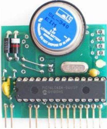
Entrada de contador para señal de voltaje. Voltaje para estado "ALTO" (para cambio de estado de contador): 3 a 24Vdc frecuencia máx. de impulsos 5kHz, operación copia de seguridad, aislamiento galvánico. El aislamiento galvánico no está diseñado como protección de seguridad. (es)
