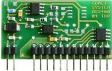
Entrada binaria para contactos de menor potencial. Resistencia máxima de contacto cerrado: 1000 ohms. Duración mínima de grabación: 200ms. Aislamiento galvánico. El aislamiento galvánico no está diseñado como protección de seguridad.
