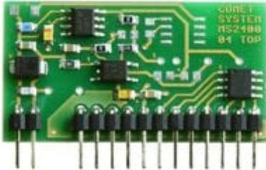
Entrada de voltaje binaria. Voltaje para "encendido ON" estado: 3 a 30 Vdc, corriente de entrada en "encendido ON": 1 a 9 mA-en función de la tensión aplicada. Duración mínima para indicación del cambio: 200ms, con aislamiento galvánico. El aislamiento galvánico no está diseñado como protección de seguridad.
