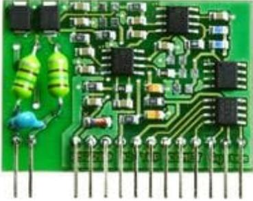
Entrada termopar B (Pt30%Rh-Pt). Rango de medición +100 a +1800°C. Precisión  $\pm 0.3\%$  de lectura + 1.0°C desde +300 a +1800°C. Linealizado, con compensación de unión fría. con aislamiento galvánico (es)
