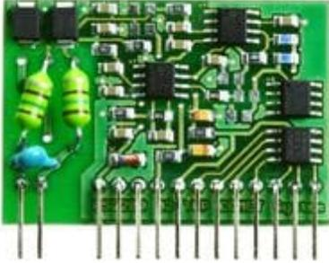
Entrada termopar K (NiCr-Ni) . Rango de medición -70 a +1300°C.
