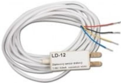
Detector de fugas de agua, salida de dos estados, se puede conectar a los reguladores con entradas binarias. Con cable de 3 metros. Alimentado por la salida de 12 Vdc del regulador.
