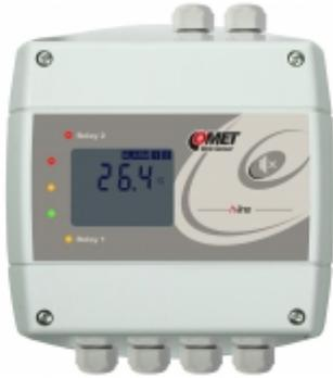
Sensor de temperatura Ethernet para sensores Pt1000 con dos salidas de relé.
