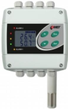
Humidistato, termostato con dos salidas de relé. Uso interior/exterior. Sensores de temperatura y humedad incorporados. Los valores medidos también se convierten a otros de interpretación de humedad: temperatura del punto de condensación, humedad absoluta, humedad específica, proporción de mezcla, entalpía específica. Tres entradas dos estados.
