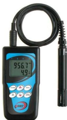
Termómetro, higrómetro diseñado para la medición y registro de datos de temperatura, humedad relativa en la memoria interna no-volátil. Programa gratuito de PC que permite transferir los datos grabados en el ordenador para su evaluación. Pantalla LCD retroiluminada.
