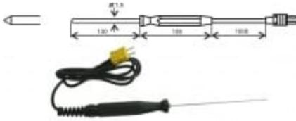
Sonda de aguja de penetración rápida para materiales blandos tipo CZ 550 -65 a + 550 ° C, el tiempo de respuesta aproximadamente 3s t90, parte metálica de acero inoxidable V4A
