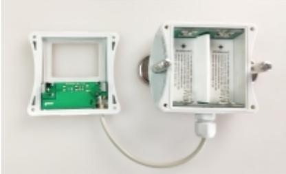
El portapilas con imanes SP015M está diseñado para montar sensores inalámbricos con salida de red Sigfox en superficies magnéticas.
