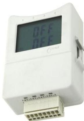
Registrador de 4 canales diseñado para el registro de señales de dos estados. Los valores son almacenados en memoria electrónica no volatil. La transmisión de datos al ordenador personal para su posterior análisis se realiza mediante USB, RS232, GSM o interfaz Ethernet por medio de un adaptador adecuado.
