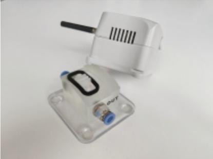
El accesorio está diseñado para verificar la precisión de la medición (calibración) y el nuevo ajuste de los instrumentos.
