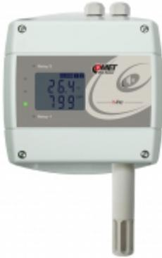
Sensor de nivel de temperatura, humedad, Co2 con dos salidas de relés. El sensor H6520 está diseñado para la monitorización online de temperatura, humedad relativa del aire sin sustancias agresivas. Otros dispositivos pueden ser controlados por dos salidas de relé.
