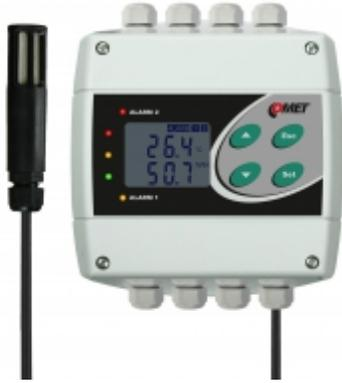
Humidistato, termostato con dos salidas de relé. Uso interior/exterior. Sonda de cable de temperatura y humedad relativa. Los valores medidos también se convierten a otros de interpretación de humedad: temperatura del punto de condensación, humedad absoluta, humedad específica, proporción de mezcla, entalpía específica. Tres entradas dos estados.
